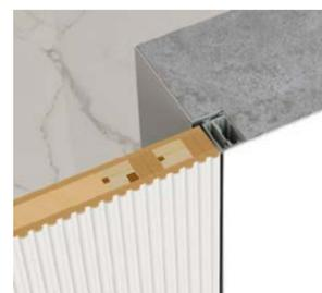
Короб прямого открывания А45, толщина полотна 45 мм
