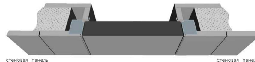
2. скрытый алюминиевый короб A40 + стеновая панель. открывание полотна внутрь.
