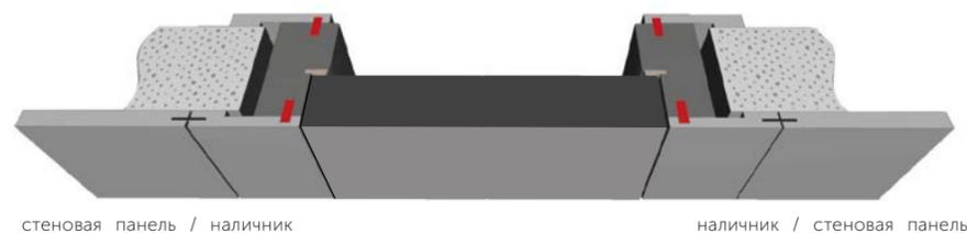
5. компланарный короб + стеновая панель. открывание полотна наружу.
