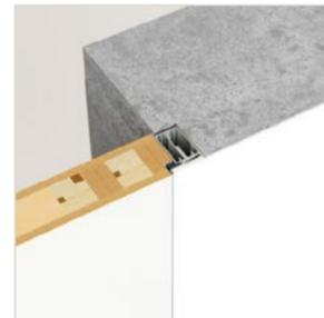
Полотно реверсивного открывания. Короб А40, толщина полотна 53/54 мм
