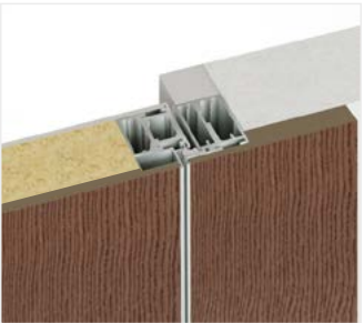
Полотно реверсивного открывания, толщина полотна 60 мм
