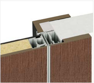
Полотно прямого открывания, толщина полотна 45 мм
